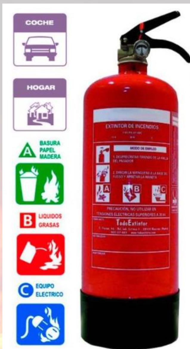
**Extintor de Polvo Químico ABC de 3 kgs de** capacidad, completo, pintado en rojo RAL-3000. Incluye manómetro de latón, base de plástico y soporte mural. Diámetro: 130 mm Altura: 420 mm. Soldadura en la parte inferior del cilindro. Homologado y Certificado. Fabricado según EN 3/96. Casco marcado CE. Eficacia 13 A 89 BC.
